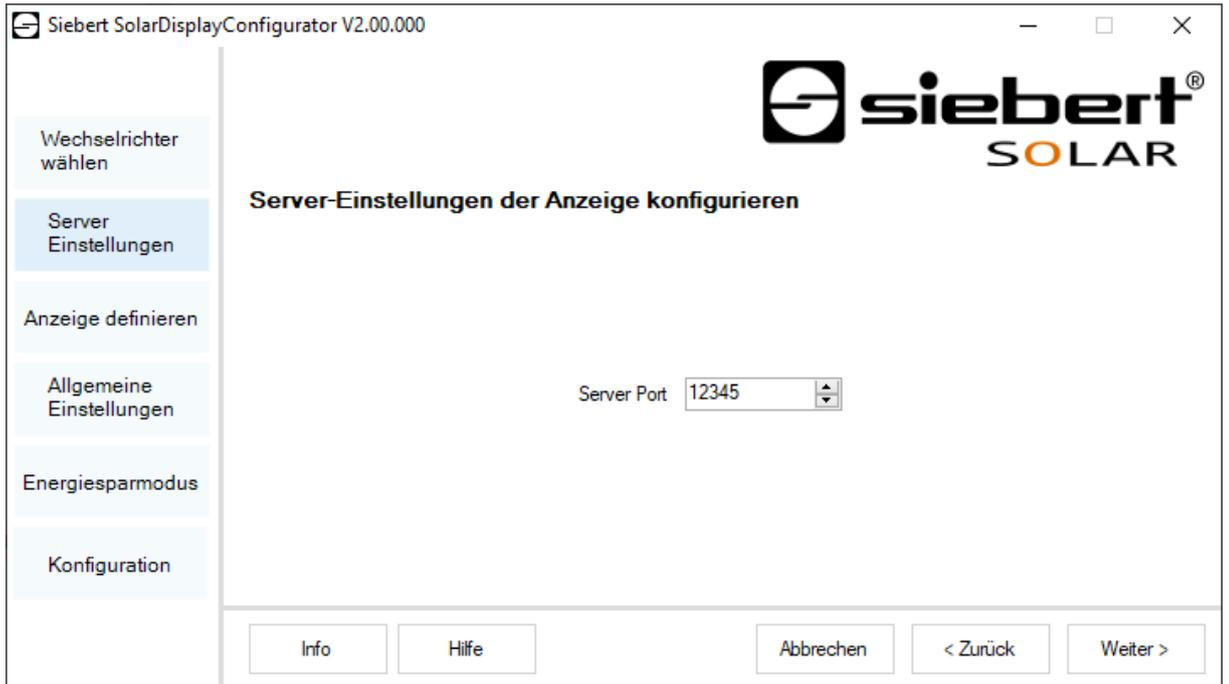
Bei manchen Ethernet Datenloggern muss die Anzeige als Server fungieren und der Datenlogger verbindet sich als Client mit der Anzeige. Unter 'Server Port' wird der Netzwerk-Port angegeben über den sich der Client mit der Anzeige verbinden kann. Damit der Datenlogger die Verbindung zur Anzeige herstellen kann, müssen die IP-Adresse der Anzeige und der Server Port der Anzeige in der Konfiguration seitens des Datenloggers eingetragen werden.
