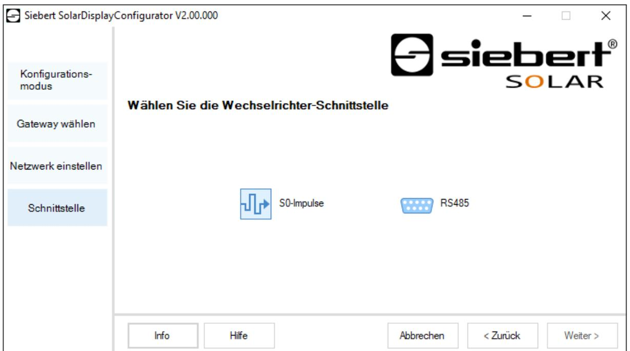
Wenn Sie sich im Modus 'Gateway' befinden, müssen Sie hier die Schnittstelle des Wechselrichters auswählen, der an das Siebert Ethernet Gateway angeschlossen werden soll. Die Daten des Wechselrichters können dann von einer Siebert Solaranzeige mit Ethernet-Schnittstelle vom Siebert Ethernet Gateway abgefragt und dargestellt werden.
