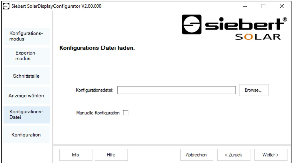
Dieser Schritt ermöglicht die Konfiguration der Anzeige mit Hilfe einer Konfigurations-Datei durchzuführen. Erforderlich ist dies, wenn die Anzeige nicht dem Serienprogramm entspricht oder Sie die Konfigurations-Datei, die durch die Konfiguration einer virtuellen Anzeige erzeugt wurde, verwenden möchten. Klicken Sie auf die Schaltfläche 'Browse', um die gewünschte Konfigurations-Datei auszuwählen und anschliessend auf 'Weiter'.
