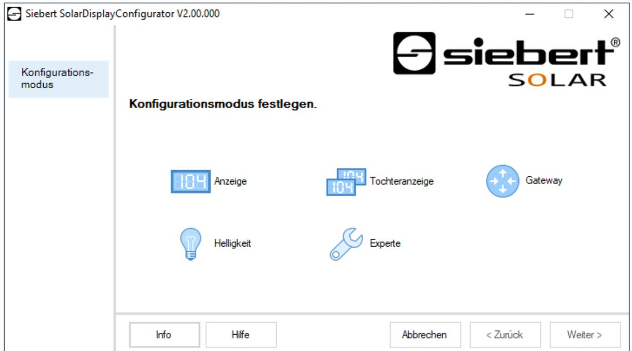
Im Modus 'Anzeige' oder 'Gateway' wird die vollständige Konfiguration der Anzeige bzw. des Gateways durchgeführt. Dabei werden alle erforderlichen Parameter eingestellt.
