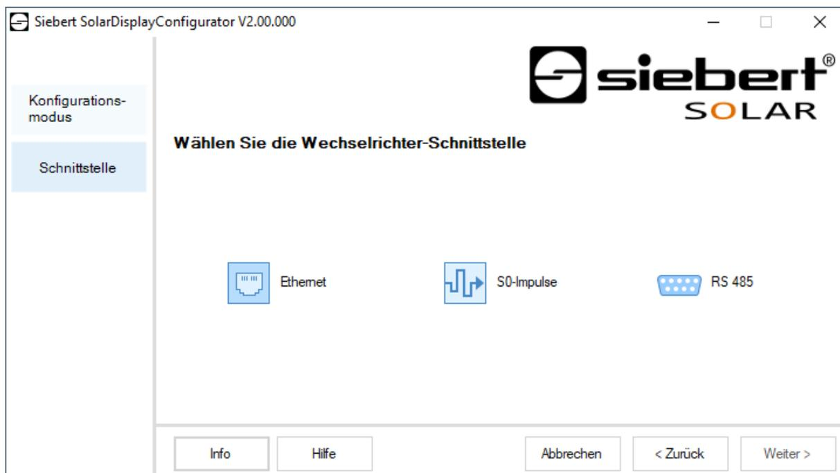
Wird der Wechselrichter bzw. Datenlogger über eine S0-Schnittstelle bzw. einen Impulsausgang mit der Anzeige verbunden, wählen Sie 'S0-Impulse'.
